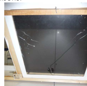
Réflexion de la lumière au moyen d'une parabole – Rupture de la vitre suite à une concentration des rayons
