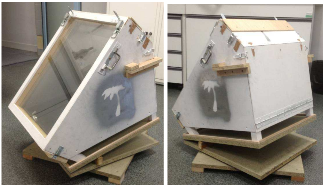
Dispositifs pour permettre une rotation simple dans le plan horizontal et une inclinaison dans le plan vertical.
