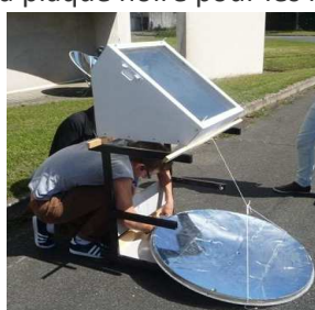
Réflexion de la lumière au moyen d'une parabole – Rupture de la vitre suite à une concentration des rayons
