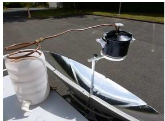
Distillation au moyen d'une parabole solaire
