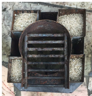
Disposition de l'isolant et des arrivées d'air dans le modèle n°3
